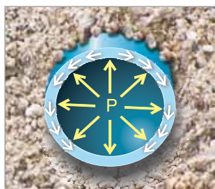
Vnitřní tlak – kruhové napětí v tahu na trubce.
